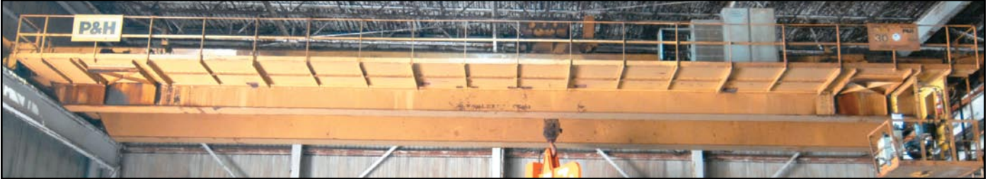
P&H 30 ton bridge crane
